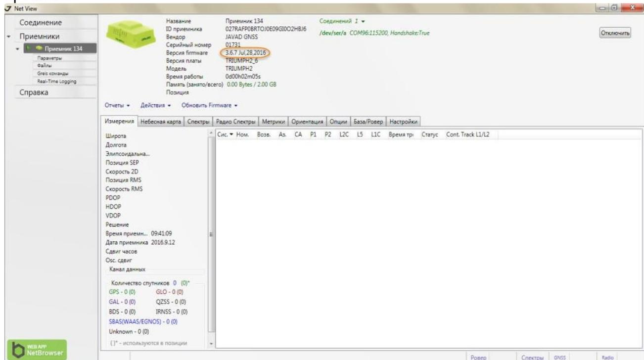
6. Для обновления прошивки нажимаем «Обновить Firmware» -> «с веб сайта» -> стабильная версия
