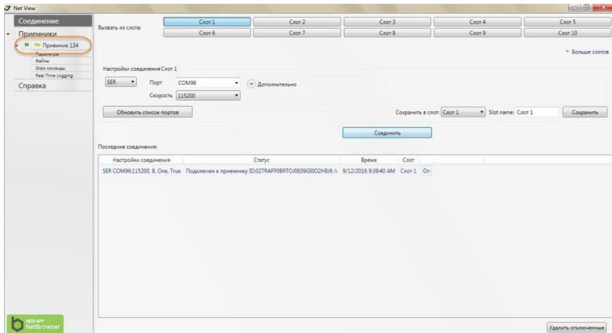
5. Нажимаем на приемник, чтобы посмотреть все свойства в том числе и версия прошивки
