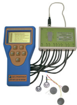
ИТП-МГ4.03/Х(I) «Поток» (где Х – общее количество измерительных каналов) предназначен для измерения и регистрации плотности тепловых потоков, проходящих через однослойные и многослойные ограждающие конструкции зданий и сооружений по ГОСТ 25380, через облицовку и теплоизоляцию энергообъектов при экспериментальном исследовании и в условиях эксплуатации.
